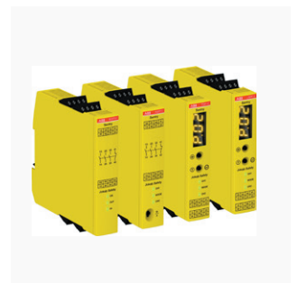
08 Bezpečnostní relé - Bezpečnostní relé řady Sentry patří mezi výkonná a uživatelsky bezpečná zařízení. Monitorují vypínače nouzového zastavení (E-stop) a další typy bezpečnostních prvků v zařízeních bezpečnostní kategorie do úrovně PLe/SIL3
